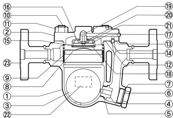
1. ※:スクリーンとフロートカバーはスポット溶接による一体式です。
