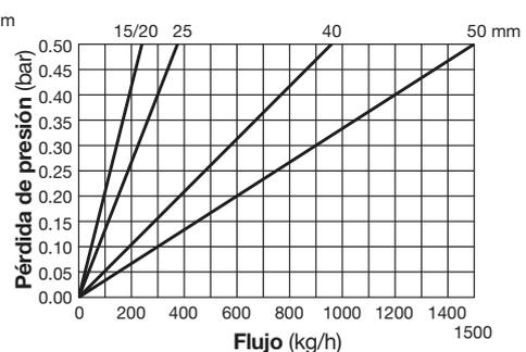
Estos gráficos de pérdida de presión se basan en una presión de vapor de 1 barg. Para otras presiones, multiplique el caudal de vapor por el factor de corrección indicado en la tabla de la derecha. Utilice el resultado en la tabla de pérdida de presión.
