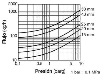
La tabla de la izquierda se utiliza para determinar el flujo de vapor que pasa por el filtro-separador SF1. Basado en una velocidad de vapor en las tuberías de 30 m/s. Para otros casos, utilice la ecuación siguiente y sustituya "v" por la velocidad de su vapor:
