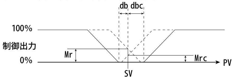
④ 加熱側PID+冷却側ON-OFF動作 ( $P \neq 0.0^*$ 、 $I \neq 0^*$ 、 $Pc=0.0$ )
