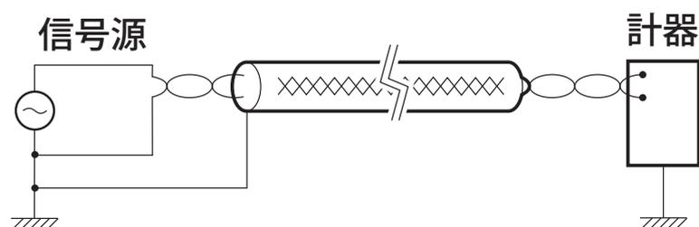
信号源が接地されていない場合には、本計器側でシールド接地します。
