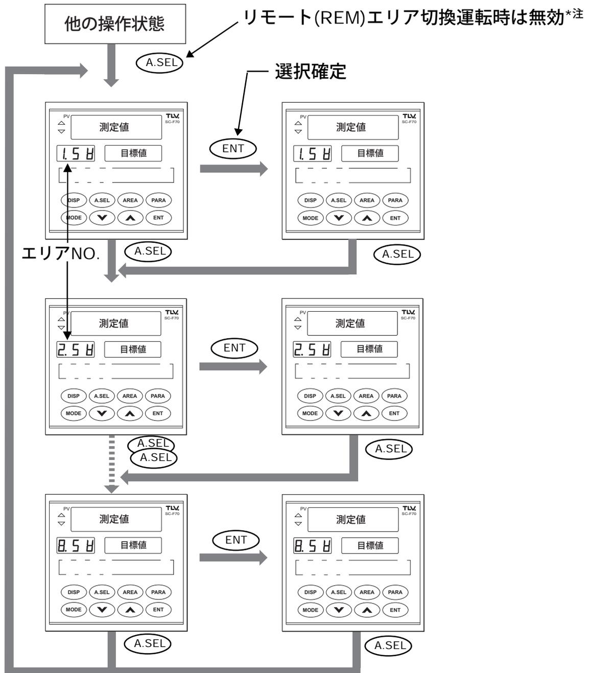
注：リモート(REM)エリア切換運転時は (A.SEL) は無効でE22エラーを表示します。LOCモードに変更してから操作します。
