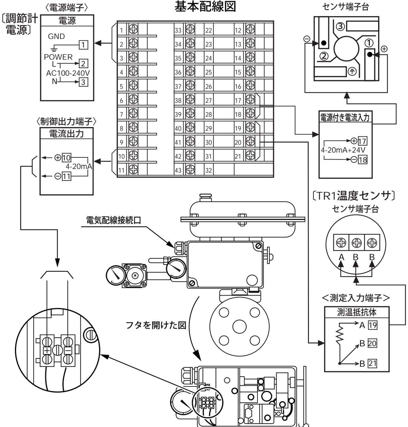
(2)加熱・冷却PID動作の例
