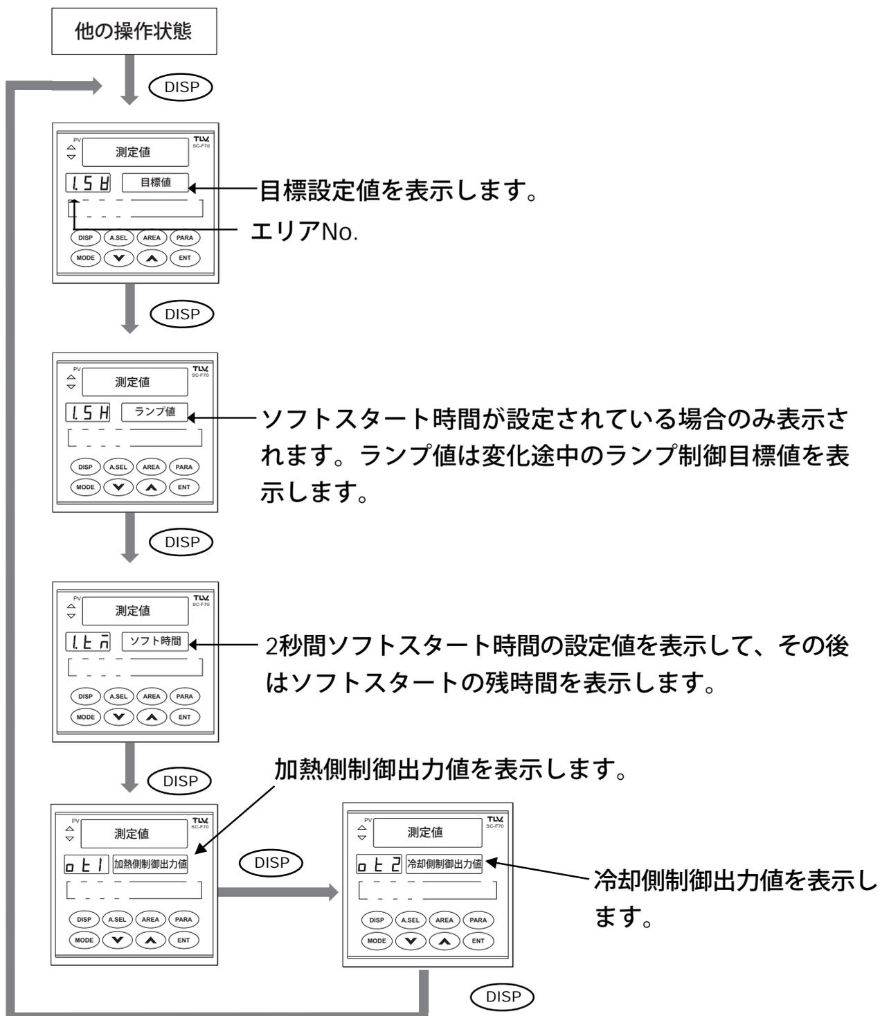
注1：MAN(手動)モード時は、モードをMANに切り換えた時点の制御出力値を維持します。 $\wedge$   $\vee$  キーによって制御出力値を手動で変更することはできません。
