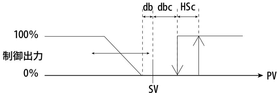
⑤ 加熱側PID+冷却側PID動作 ( $P \neq 0^*$ 、 $I \neq 0^*$ 、 $Pc \neq 0^*$ )
