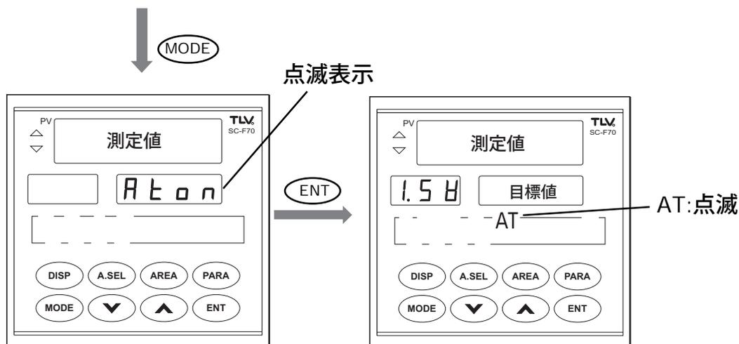
⚠ Aton点減状態で **ENT** キーを押すと、オートチューニングが実行されます。このとき、ATが点減してオートチューニングが実行中であることが示されます。
