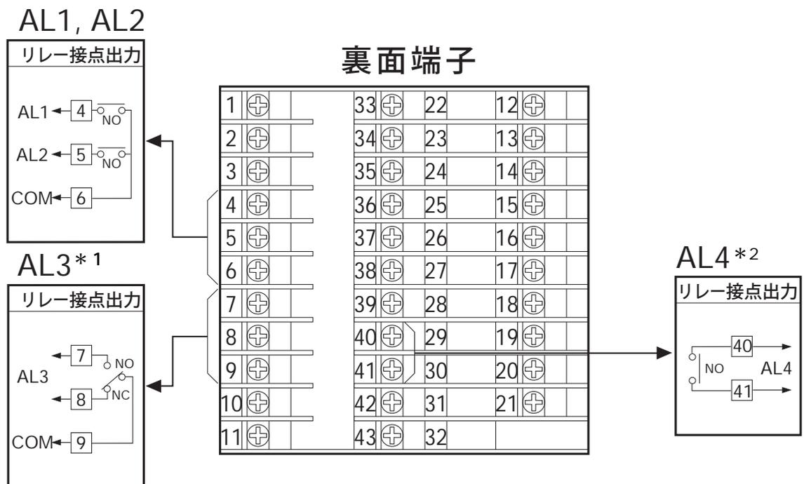
\*1:制御出力または、加熱側制御出力がリレー接点出力のときは使えません。
