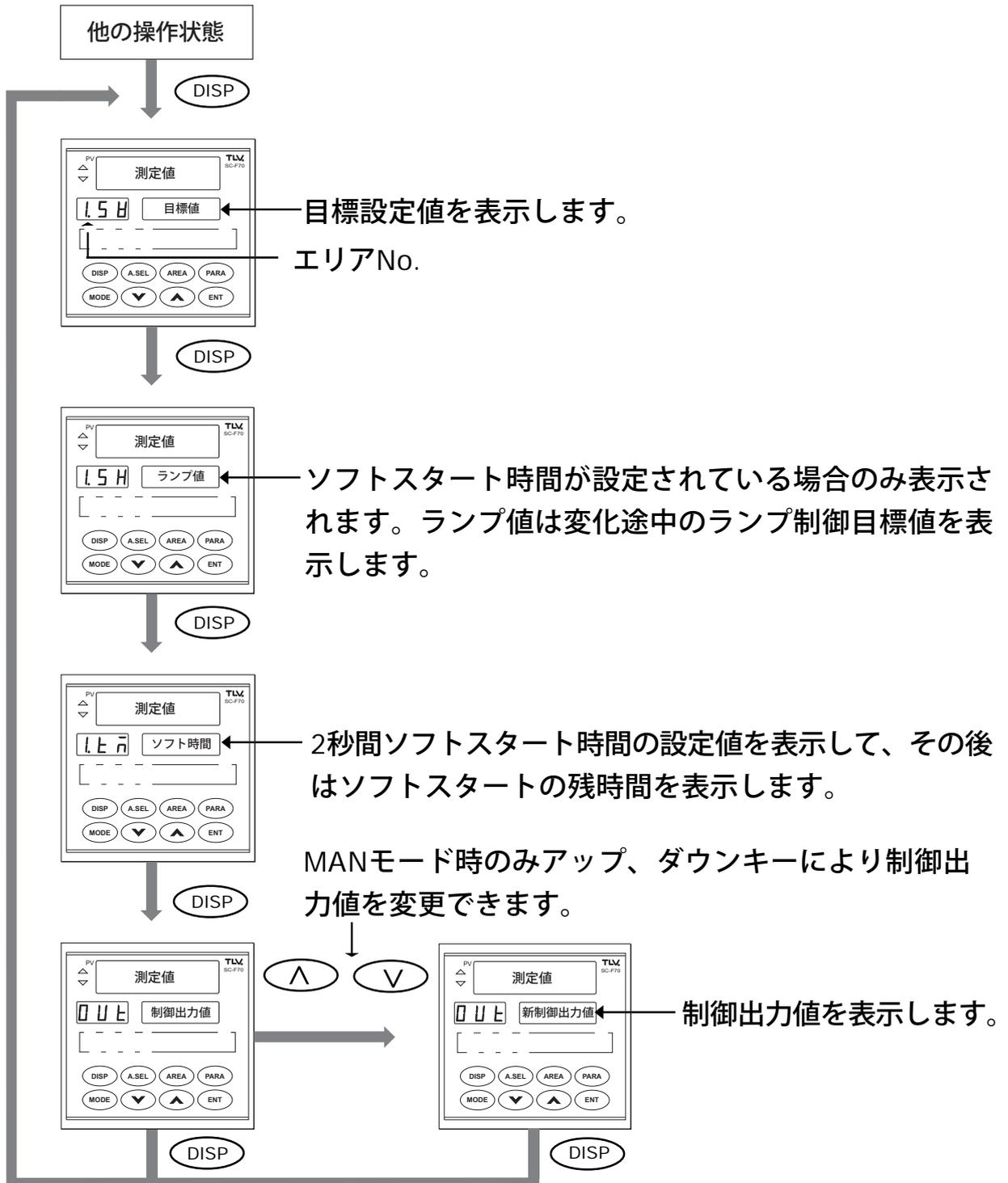
注： MAN(手動)モード時は他の操作状態から DISP キーを押すと最初に制御出力値を表示します。
