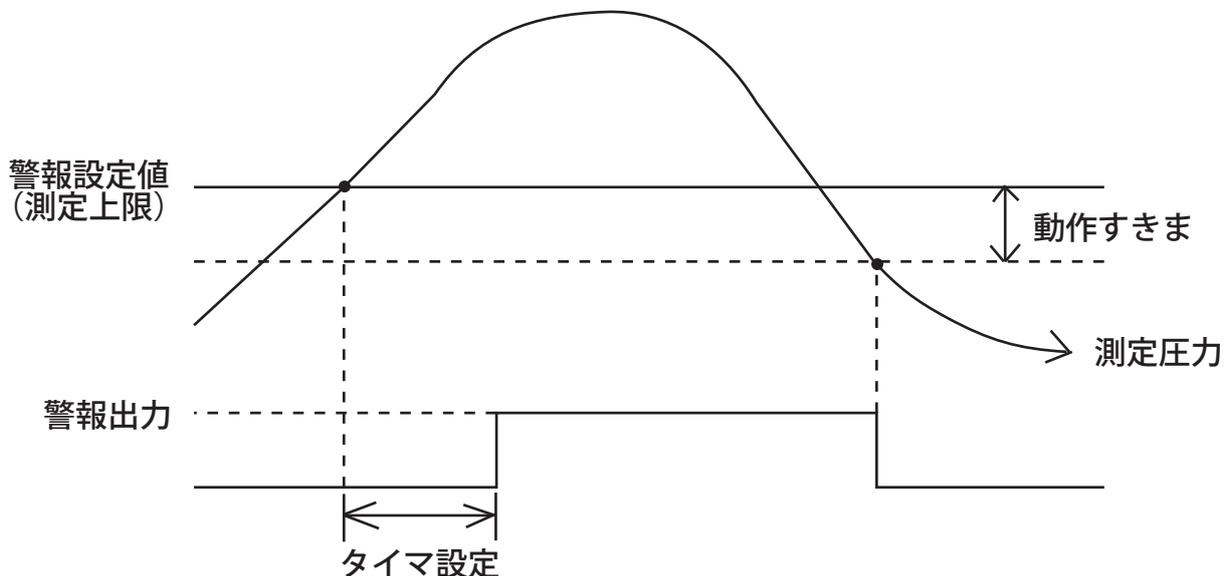
**動作すきま：**測定圧力のフラツキで警報出力が頻繁に動作するのを防止するために、差(すきま)を設けます。
