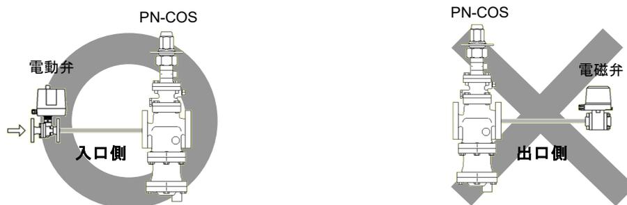
蒸気使用装置への蒸気供給停止を目的に、電動弁などの ON/OFF 弁を取付ける場合には、PN-COS-16 の入口側へ取付けてください。
