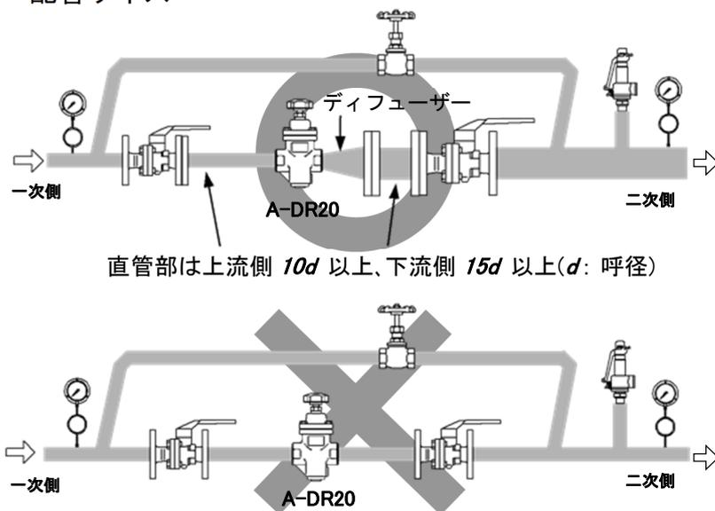
二次側で管内流速が  $30\text{m/s}$  を越えることが予想される場合は、ディフューザーを設け、管内流速を  $30\text{m/s}$  以下に押さえるようにしてください。
