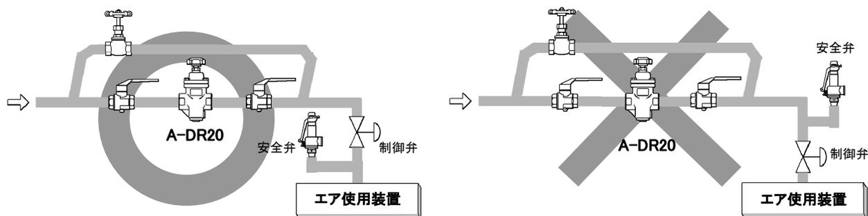
装置の制御を目的に A-DR20 の二次側に制御弁を取付ける場合、制御弁閉止時にスペースの関係上 A-DR20 と制御弁の間で昇圧することがあります。したがって安全弁は制御弁の二次側に取付けてください。
