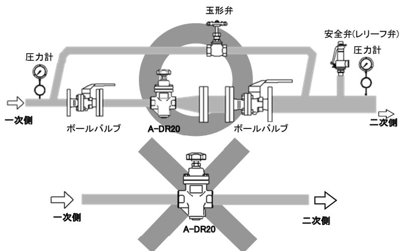
入口および出口側のストップ弁、圧力計、バイパスは、必ず設置してください。
