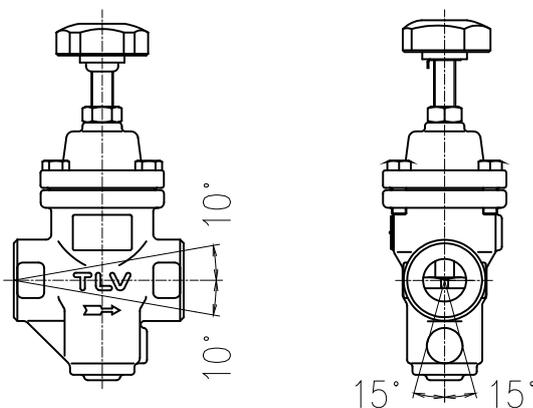
ボディの矢印と流体の流れ方向が水平に一致するように、またハンドルが上部になるように垂直に取付けてください。
