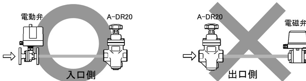
使用装置へのエアの供給停止を目的に、電動弁などの ON/OFF 弁を取付ける場合には、A-DR20 の入口側へ取付けてください。
