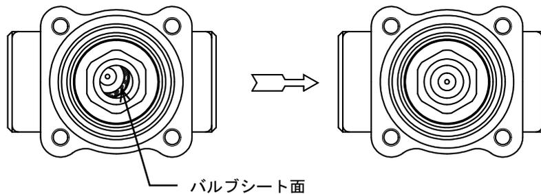
バルブシートを締付けた際、メインバルブが図のようにバルブシート面からズレる場合がありますので、メインバルブをバルブシートの中心へもどしてください。
