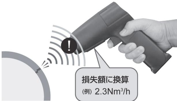
図3 ガスリークによる超音波検出
