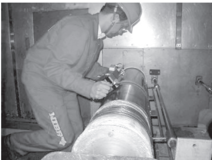
写真3 パラライン計測器による実際の測定風景
