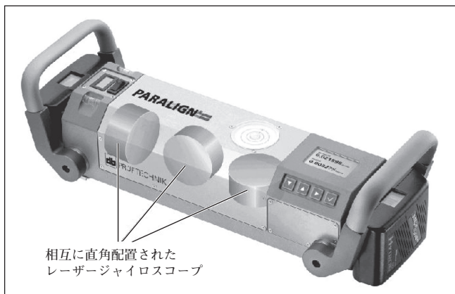
図2 リングレーザージャイロの配置
