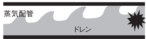
図-2 蒸気とドレンの流速の差によるウォーターハンマー
