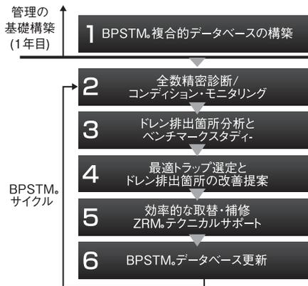
図11 ドレン排出箇所管理プログラムのプロセスフロー
