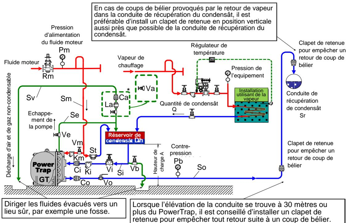
Note: Cette esquisse sert d'explication uniquement, et ne doit pas servir de dessin d'installation. Dans les applications à circuit fermé, le fluide moteur doit être compatible avec le liquide pompé. Lorsque le fluide moteur est un gaz non condensable comme de l'air ou de l'azote, veuillez demander assistance auprès de TLV.
