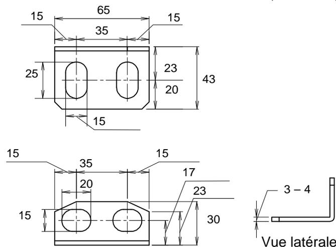
Les fixations sont conçues de façon à ce que le corps puisse être dégagé (dans la direction opposée à celle du couvercle). Une utilisation inappropriée ou l'utilisation d'autre fixations que celles fournies peut nuire à la mobilité du corps et aux opérations de maintenance.
