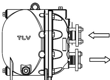
Assurez-vous que la flèche sur le clapet de retenue correspond à la direction du flux.
