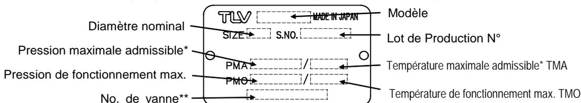
\* La pression maximale admissible (PMA) et la température maximale admissible (TMA) sont DES CONDITIONS DE CONCEPTION, **PAS** DES CONDITIONS DE FONCTIONNEMENT.
