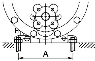
Position de montage pour les boulons d'ancrage
