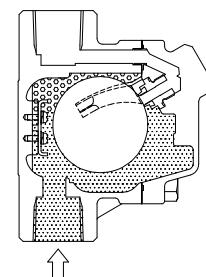
3. L'eau maintient la vanne en position fermée. Si de l'air entre dans le purgeur d'air, l'air fait baisser le niveau d'eau, ce qui ouvre la vanne en diminuant la flottabilité du flotteur. Une fois l'air évacué, le niveau d'eau remonte et la vanne se referme. L'évent d'air s'adapte ainsi aux variations de débit d'eau en ajustant l'évacuation d'air.
