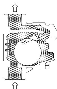
2. Une fois l'expulsion terminée, lorsque de l'eau pénètre dans l'évent d'air, l'élévation du niveau d'eau fait monter le flotteur et ferme la vanne.
