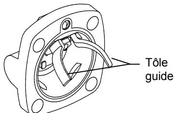
NOTE: Les guides du flotteur sont positionnés correctement à la sortie de l'usine. Veillez donc à les manier soigneusement. L'étanchéité ne peut être garantie si les guides du flotteur ne sont plus à leur position initiale.
