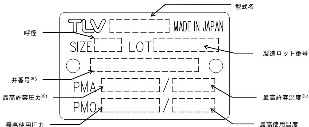
※1：最高許容圧力 PMA：耐圧部(本体)が許容される最高圧力で、最高使用圧力ではありません。
