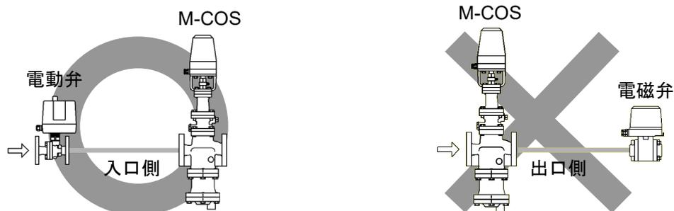
蒸気使用装置への蒸気供給停止を目的に、電動弁などの ON/OFF 弁を取付ける場合には、M-COS の入口側へ取付けてください。
