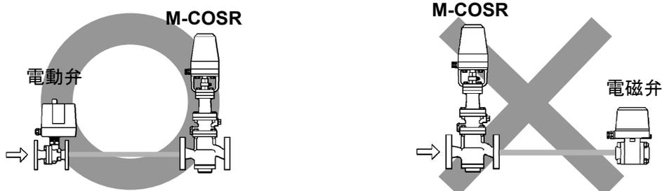
蒸気使用装置への蒸気供給停止を目的に、電動弁などの ON/OFF 弁を取付ける場合には、M-COSR の入口側へ取付けてください。
