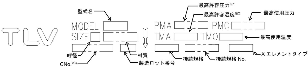
※1：最高許容圧力 PMA：耐圧部(本体)が許容される最高圧力で、最高使用圧力ではありません。
