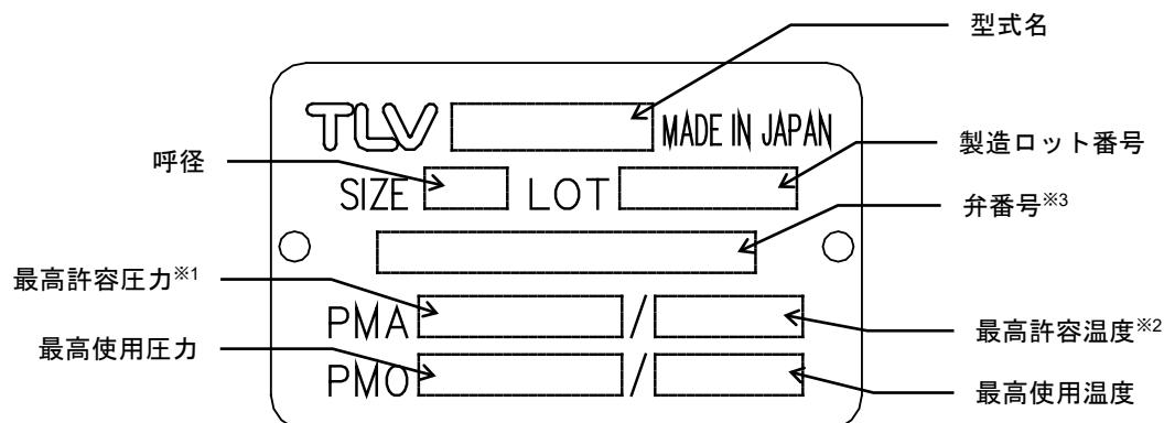
※1：最高許容圧力 PMA：耐圧部(本体)が許容される最高圧力で、最高使用圧力ではありません。
