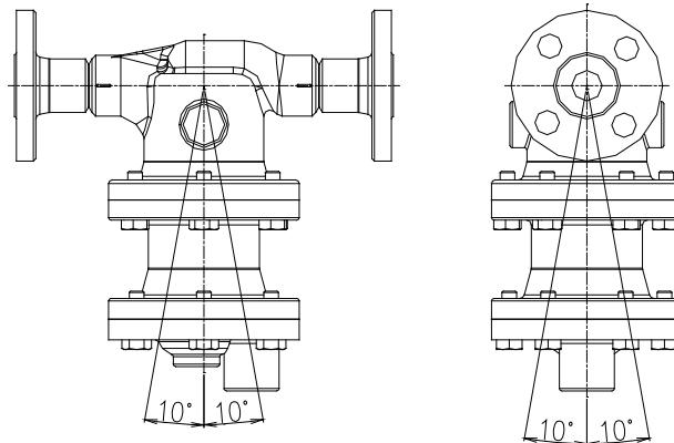
本体の鋳出し文字 (TLV) が水平に読めるように取付けます
