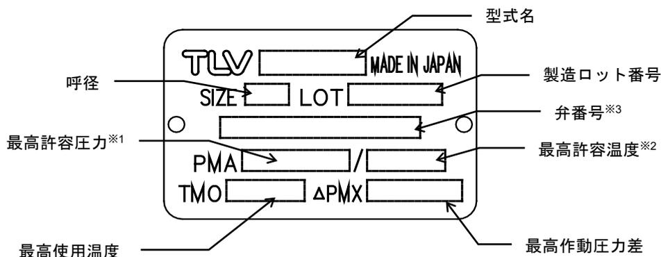
※1：最高許容圧力 PMA：耐圧部(本体)が許容される最高圧力で、最高使用圧力ではありません。
