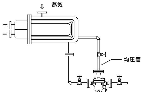
均圧管はトラップと機器または配管の蒸気部分に接続してください。
