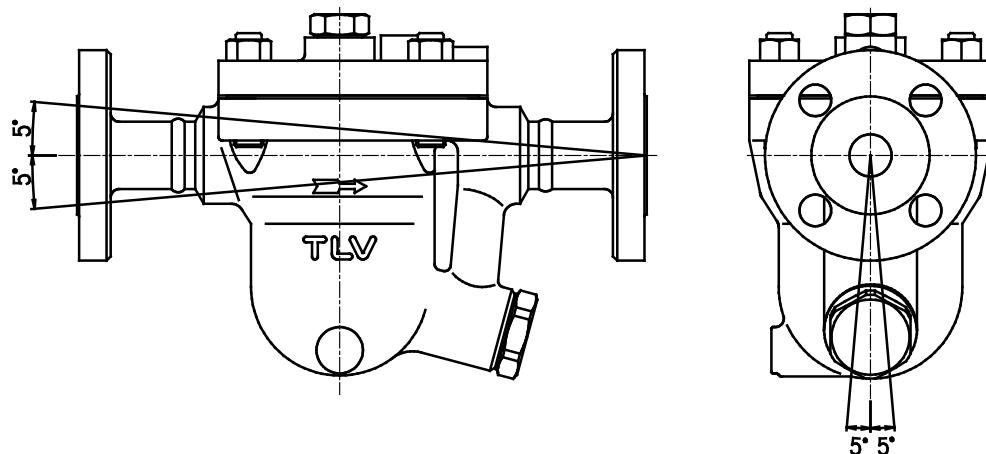
トラップ本体の鋳出し文字（TLV）が水平に読めるように取り付けます
