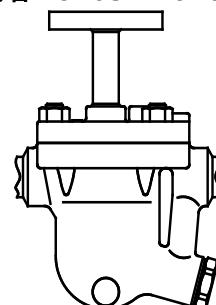
※ スチームトラップは、本来流入してきたドレンを自動的に継続して排出しますが、流入してきた低温ドレンが配管内でトラップへの入口通路をふさいでしまうと、配管内の蒸気とドレンがおきかわらないためにドレンがトラップ内に流入できなくなります。（スチームロッキング現象）
