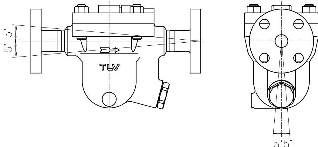
トラップ本体の鋳出し文字 (TLV) が水平に読めるように取り付けます
