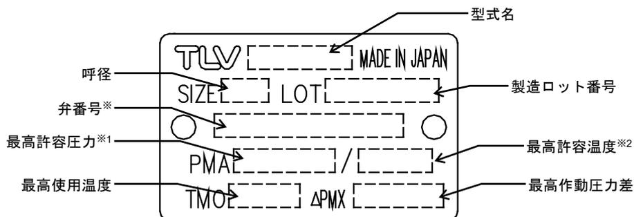
※1：最高許容圧力 PMA：耐圧部(本体)が許容される最高圧力で、最高使用圧力ではありません。
