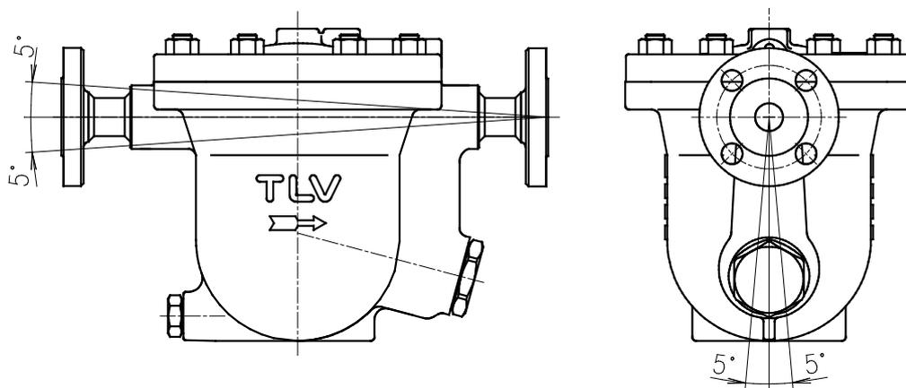
トラップ本体の鋳出し文字（TLV）が水平に読めるように取付けます
