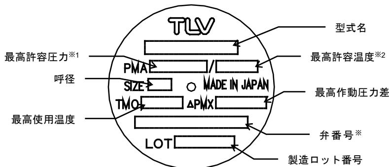
※1：最高許容圧力 PMA：耐圧部(本体)が許容される最高圧力で、最高使用圧力ではありません。
