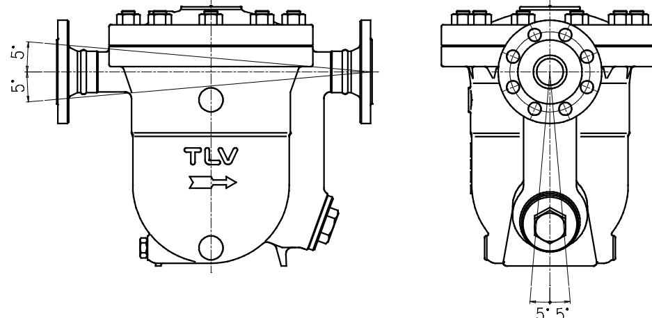
トラップ本体の鋳出し文字 (TLV) が水平に読めるように取付けます
