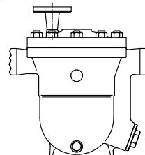
※ スチームトラップは、本来流入してきたドレンを自動的に継続して排出しますが、流入してきた低温ドレンが配管内でトラップへの入口通路をふさいでしまうと、配管内の蒸気とドレンがおきかわらないためにドレンがトラップ内に流入できなくなります。（スチームロッキング現象）
