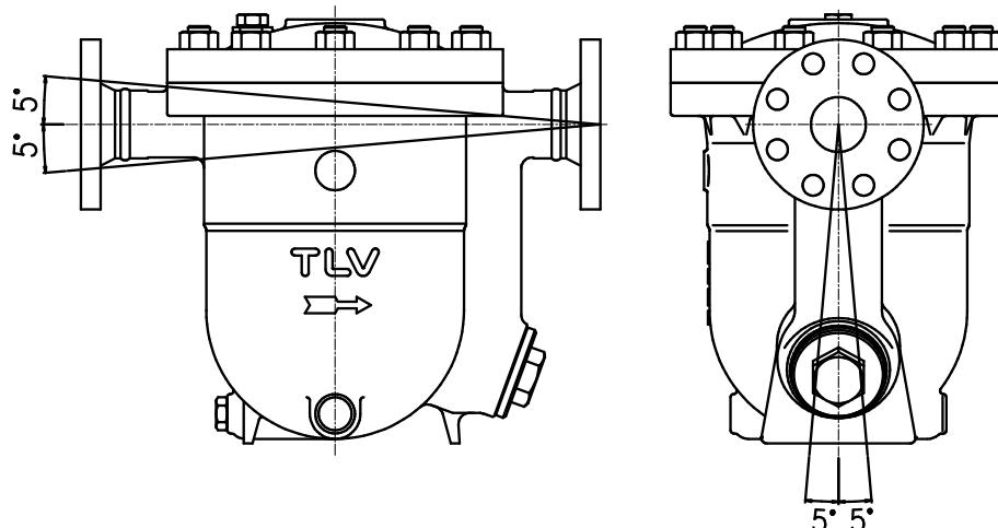
トラップ本体の鋳出し文字（TLV）が水平に読めるように取り付けます
