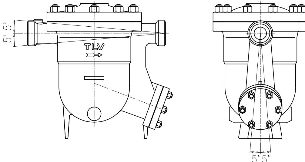
トラップ本体の鋳出し文字（TLV）が水平に読めるように取付けます
