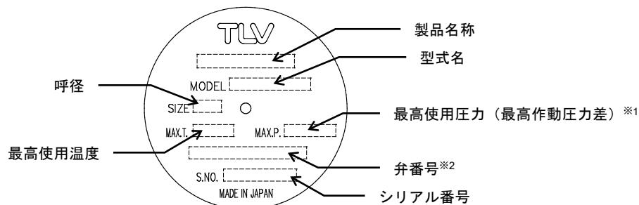
\*1 : MAX.P.の箇所に最高作動圧力差の圧力を表示しています。
