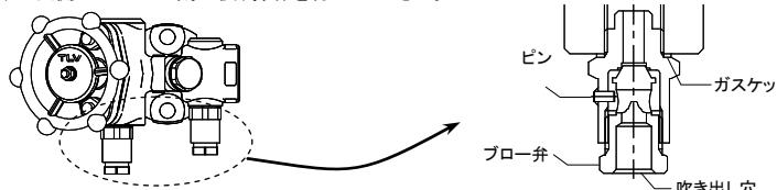
1. 出荷時、プローダウンバルブ・テストバルブのブロー弁は閉弁した状態で出荷されています。
