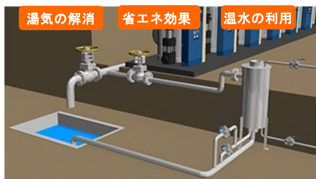
ボイラー連続ブロー
