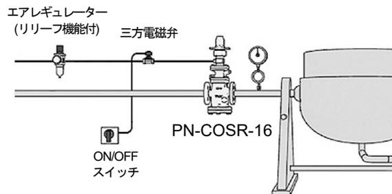
手動制御にて2点の二次側圧力を ON/OFF スイッチで切り替えることができます。供給空気を調整するエアレギュレーター（リリーフ機能付）、三方電磁弁、ON/OFF スイッチが必要となります。1点目の高圧側の圧力設定は供給空気によって、二次側圧力ゲージを見ながらエアレギュレーターにて調整を行います。2点目の低圧側の圧力設定は、以下の「調節ネジによる設定を行う場合」の手順に従って行います。
