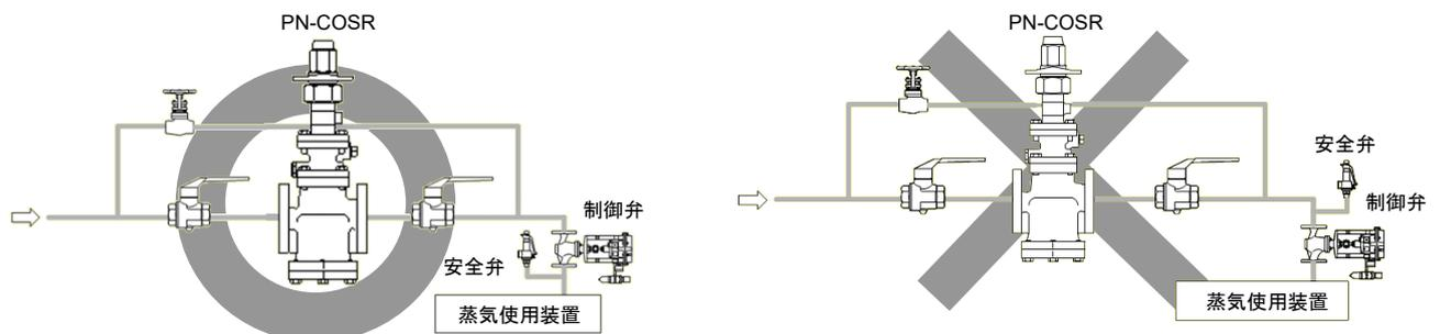
装置の温度制御を目的に PN-COSR-16 の二次側に制御弁を取付ける場合、制御弁閉止時にスペースの関係上 PN-COSR-16 と制御弁の間で昇圧することがあります。したがって安全弁は制御弁の二次側に取付けてください。
