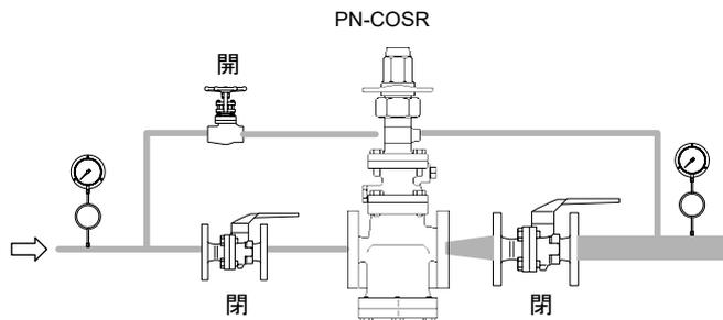
PN-COSR-16 の取付け前に、配管内のブローをしてください。もしできなければ、バイパスを利用してブローしてください。とくに、新設配管や長期止管には必ず行ってください。
