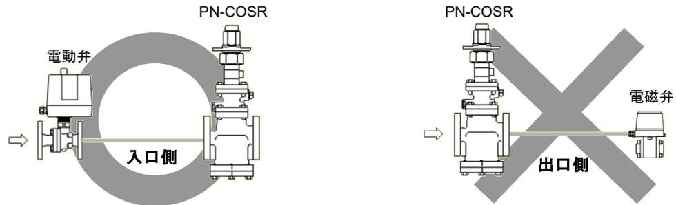
蒸気使用装置への蒸気供給停止を目的に、電動弁などの ON/OFF 弁を取付ける場合には、PN-COSR-16 の入口側へ取付けてください。
