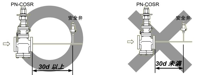
制御弁または自動弁 (ON-OFF 弁) を設置する場合、長さ 30d 以上 の直管部を設けてください。
