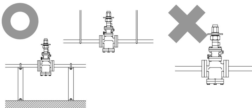
PN-COSR-16 に無理な荷重、曲げ、振動などが伝わらないように配管してください。
