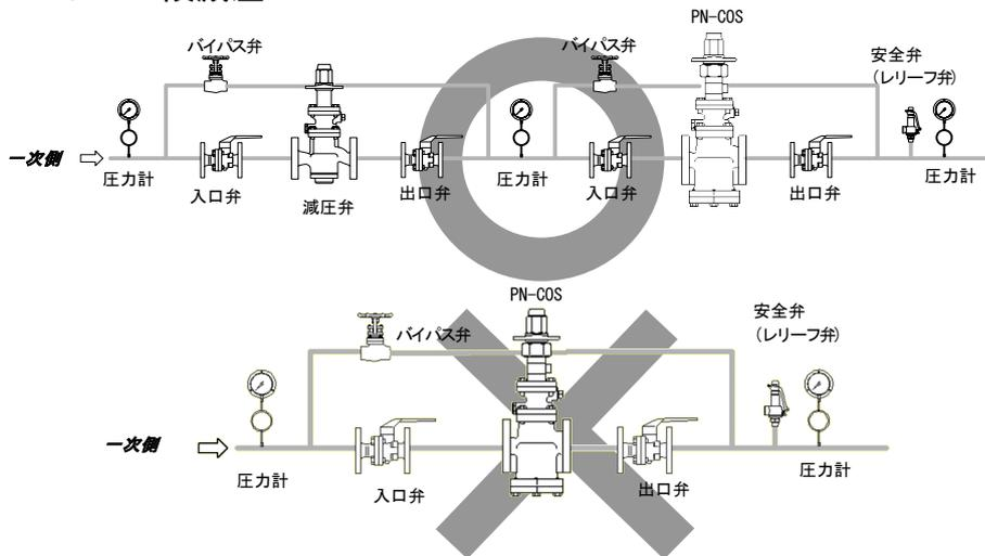
減圧比が 10 : 1 を超える等の使用可能範囲の制限で PN-COSR-16 1 台では希望の圧力まで減圧できない場合は、一次側に減圧弁を設けてください。
