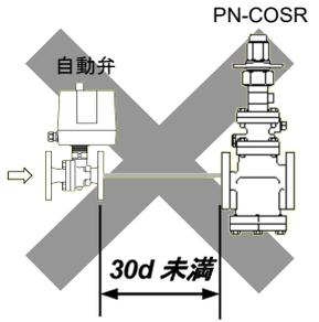
減圧弁を設置する場合、長さ **30d 以上** の直管部を設けてください。
