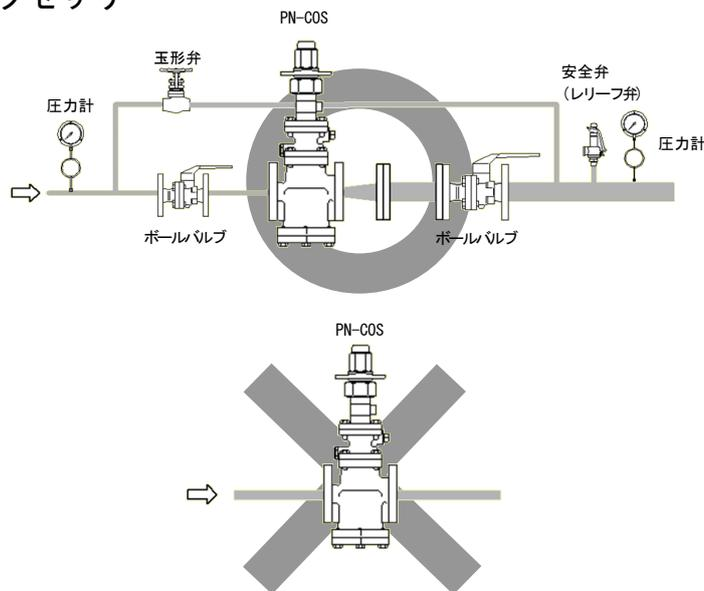
入口および出口側のストップ弁、圧力計、バイパスは、必ず設置してください。
