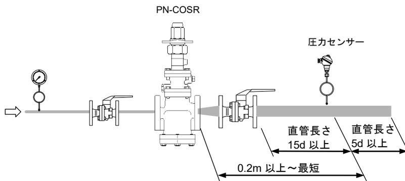
PN-COSR-16 設置位置から圧力センサー設置位置までの配管距離は、0.2m 以上で最短にしてください。距離が長くなりますと、その間での圧力損失と圧力変化遅れが大きくなり、圧力のフラツキが大きくなります。
