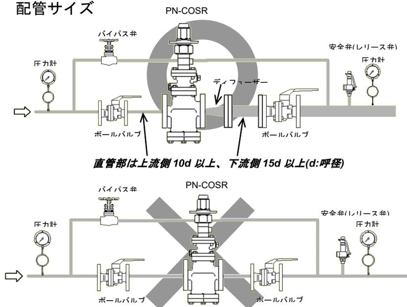
二次側で管内流速が 30m/s を越えることが予想される場合は、デューザーを設け、管内流速を 30m/s 以下に押さえるようにしてください。
