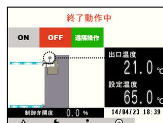
(エ) 終了動作後、本ユニットのシステムが停止します。タッチパネル内の動作表示が「停止中」となり、本ユニットの全機器(タッチパネルおよびセンサー類を除く。)が停止していることを確認してください。
