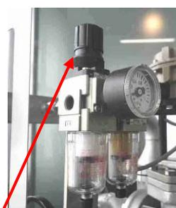
レギュレーターハンドル調整時は、ハンドルを引き上げ、オレンジ色のシールが見える状態にしてから回してください。
