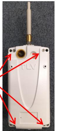
2. 内部の電池パックは、2 個装着されていますが、1 個ずつ交換してください。最初に交換したい方の電池パック固定ボルト(4 か所)を外します。
