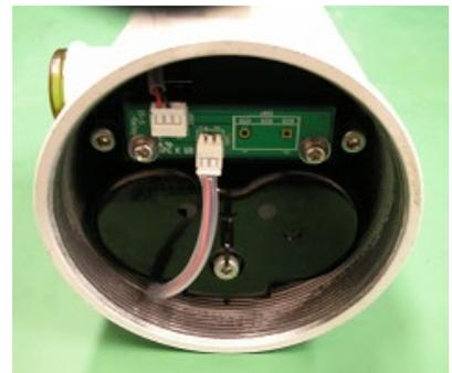
3. 六角穴付きボルト 2 本を外して、電池パックを引き上げます。
