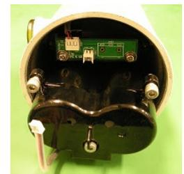
4. 新しい電池パックを挿入して、六角穴付きボルト 2 本を締め付けて固定します。
