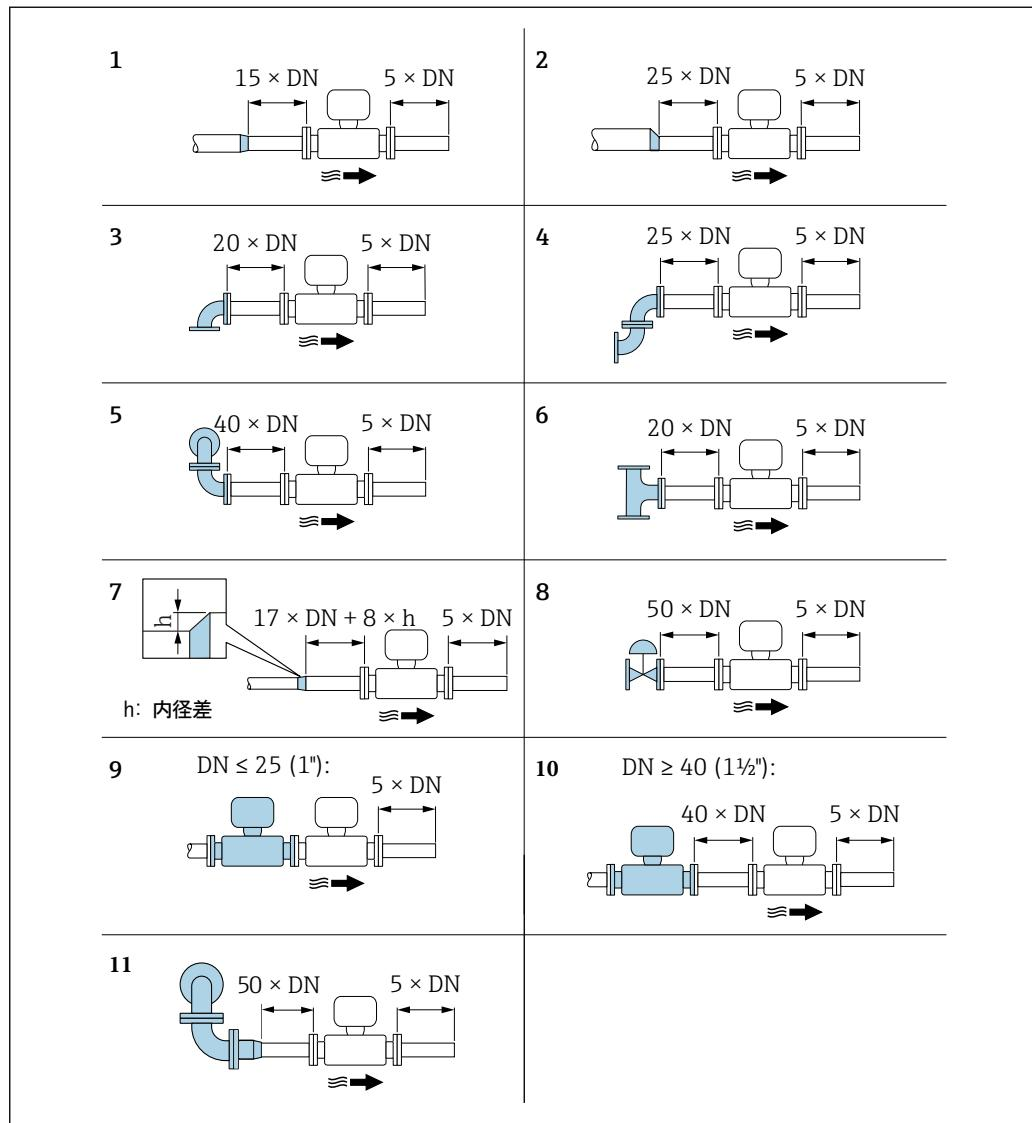
障害物が存在する場合の上流/下流側の必要直管長 (DN : 配管径)
