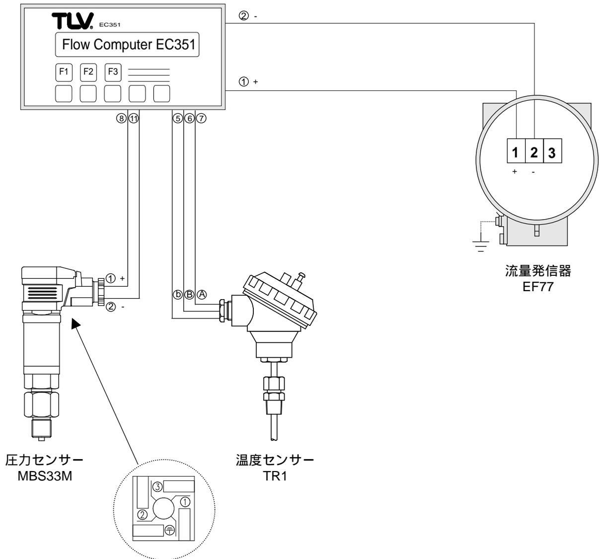
注：ノイズ防止の為シールドケーブルを使用し盤側のアースに落としてください。
