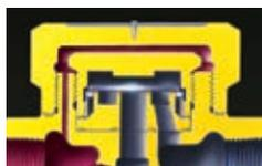
Em purgadores com tampa de camada única, as condições atmosféricas adversas e a perda de calor por radiação resulta em perda de vapor devido ao acionamento isento de condensado e vazão direta de vapor. Enquanto tais problemas são parcialmente solucionados com uma camisa de isolamento por ar, a camisa do A3N é aquecida pelo vapor e resfriada pelo condensado, e oferece a maior proteção, garantindo a operação mais estável dentre todos os purgadores de vapor termodinâmico.
