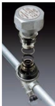
Purgadores de vapor do tipo disco falham com frequência devido ao impacto contínuo da válvula disco contra o assento de vedação. Com o módulo substituível da A3N, essas peças podem ser substituídas facilmente como um conjunto único, reduzindo o tempo de troca e custos de manutenção.
