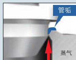
通过阀门的开关，刮除管垢，并借助蒸汽进行吹扫
