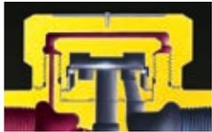
Dans les purgeurs dotés d'un couvercle à couche simple, des conditions atmosphériques défavorables et des pertes de chaleur rayonnante engendrent des pertes de vapeur
