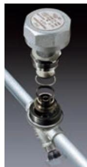
Les défaillances des purgeurs de vapeur à disque sont souvent dues à l'usure résultant de l'impact répété du disque de soupape sur le siège de soupape. Grâce au module remplaçable de l'A3N, ces pièces peuvent être facilement remplacées comme un tout, ce qui réduit la durée des remplacements et les coûts de maintenance.
