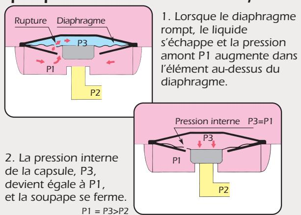
La soupape fermée entraîne une accumulation de condensât.
