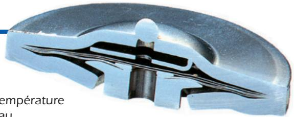
L'élément de la capsule contient un liquide dont la température de saturation est légèrement inférieure à celle de l'eau.
