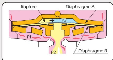
La pression P3 se rapproche de celle de P2 et le bouchon de soupape est poussé vers le haut par la pression amont P1, ouvrant la soupape.
