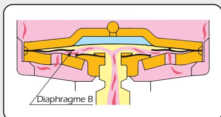
Même dans le cas extrême où le bouchon de soupape est complètement disjoint du diaphragme inférieur, le condensat peut s'échapper par le trou au centre du bouchon.
