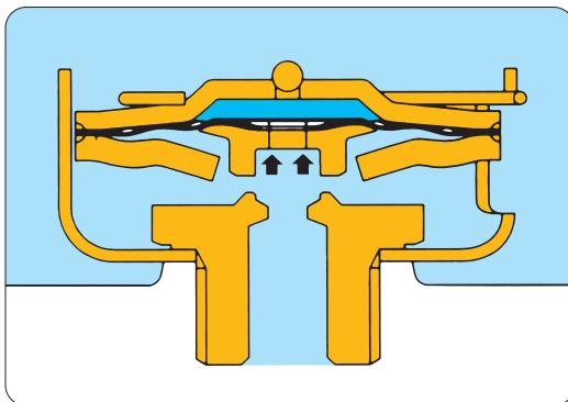
Lors de la mise en route des installations de chauffage, quand la capsule est encore froide, le liquide n'est pas vaporisé. La pression interne est inférieure à la pression externe ; le diaphragme est alors poussé vers le haut et ouvre la soupape. L'air, les gaz et le condensat sont évacués.
