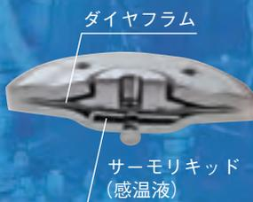
X-エレメントにはサーモリキッド (感温液) が封入されており、サーモリキッドと水との飽和温度の差によって開閉弁する新しい弁機構です。
