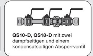
QS10-D, QS18-D mit zwei dampfseitigen und einem kondensatseitigen Absperrventil
