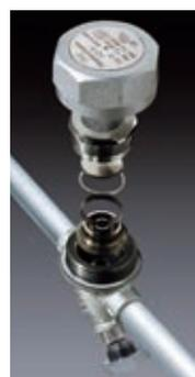
Las trampas de vapor tipo disco usualmente fallan a causa del desgaste debido a los repetidos impactos del disco con el asiento de la válvula. Con el módulo reemplazable del modelo A3N, estas partes pueden reemplazarse fácilmente como una sola unidad, reduciendo tiempo y costo de mantenimiento.
