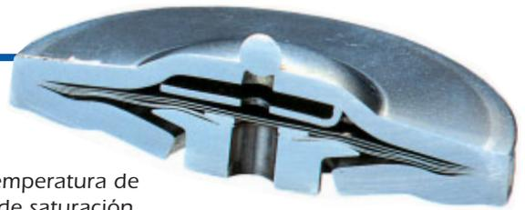
La cápsula del elemento contiene un líquido cuya temperatura de saturación es levemente menor que la temperatura de saturación del agua. Con la temperatura elevándose en la trampa, el relleno se evapora; la presión interna resultante expande al diafragma cerrando la válvula. Cuando la temperatura decrece, el relleno se condensa y la reducción de presión resultante permite al diafragma contraerse y permitir la apertura de la válvula.
