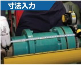
① ブラケットを取り付け、位置調整し、寸法関係を入力します
