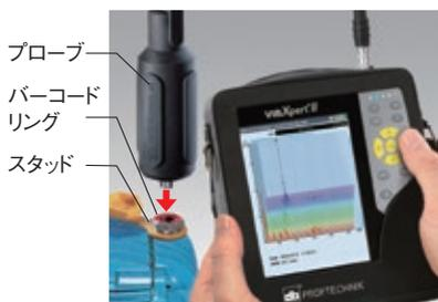
測定場所、押し付け圧力を常に一定にし、人為的測定ミスを防止します。
