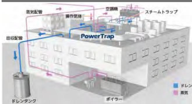
屋上に設置した機器から発生するドレンを階下のドレンタンクへ回収する場合、全体としては重力を利用した回収となりますが、屋上階単体で見ると設置されている各種機器や配管が障害物になり、回収配管に立ち上がり部ができてしまいます。立ち上がり配管部が抵抗となるため、空調機など供給蒸気圧力が低い機器は自圧で回収することができていませんでした。
