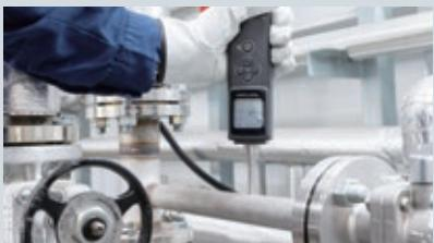
接触式センサーで、測定対象の表面温度を高精度に測定
