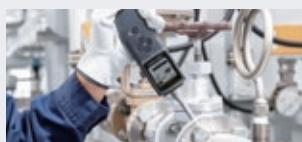
蒸気・エア等の気体配管に取付けられたバルブの内部リークの有無を自動で簡易判定
