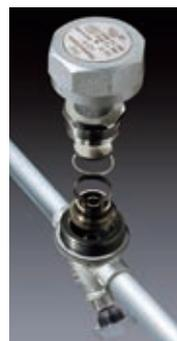
Часто дисковые конденсатоотводчики выходят из строя в результате повторяющегося удара диска клапана о седло клапана. С помощью сменного модуля АЗН эти детали можно легко сменить как единое целое, что сокращает время замены и затраты на обслуживание.
