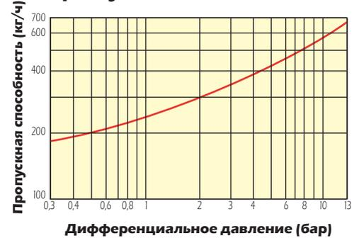
1. Дифференциальное давление — это разница между давлением на входе и выходе конденсатоотводчика
