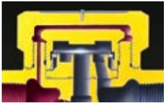
В конденсатоотводчиках с простой однослойной крышкой неблагоприятные погодные условия и теплопотери вызывают утечку пара при работе вхолостую.
