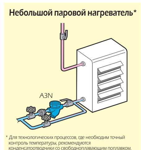
\* Для технологических процессов, где необходим точный контроль температуры, рекомендуются конденсатоотводчики со свободноплавающим поплавком.
