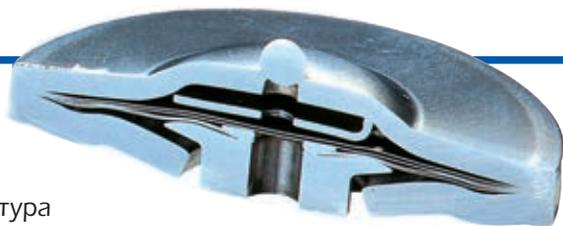
Капсульный элемент содержит жидкость, температура насыщения которой несколько ниже температуры насыщения воды. При повышении температуры в конденсатоотводчике, жидкость испаряется; повышенное давление расширяет диафрагму, чтобы закрыть клапан. Когда температура снижается, наполнитель конденсируется, в результате снижение давления позволяет диафрагме сжиматься и открывать клапан.
