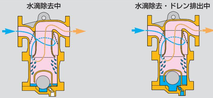
**1** 流体は入口から入り、セパレーターにより遠心力を与えられ質量の大きなドレン、水分は、本体内壁に沿って本体下部へ滴下します。
