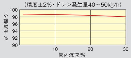
$$\text{分離効率(\%)} = \frac{\text{トラップの排水ドレン量}}{\text{流入ドレン量}} \times 100$$
