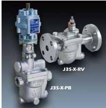
装置用トラップ。蓋部に手動・空気動・電動のバイパスブロー弁を一体化しました。J3S-X-RVは調節弁の開度を手動で調節でき、スチームロッキング対策が可能。
