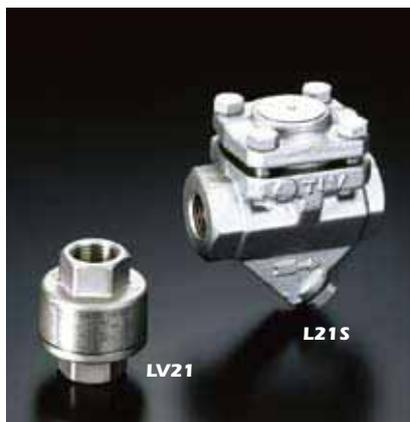
X-エレメント採用のサーモスタティックトラップ。低温ドレン・エアを急速排除することにより、立ち上がり時間を短縮するだけでなく、運転中の高温エアも自動排除します。
