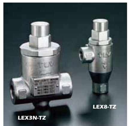
トレース用途に適したスケール除去バイメタル式温調トラップ。排出するドレンの温度を調整でき、送油管や加熱タンクのオイルや液体の温度を保ちます。スケール除去機能で簡単に弁の詰りを解消します。
