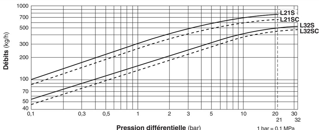
1. La pression différentielle est la différence entre les pressions à l'entrée et à la sortie du purgeur.
