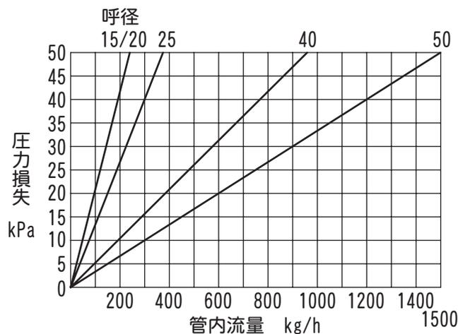
1. この圧力損失グラフは、蒸気圧0.1MPaGの時のものであります。それ以外の場合は、管内流量値 (kg/h) に下表の流量補正係数を乗じた値を用いて、図より圧力損失を求めてください。
