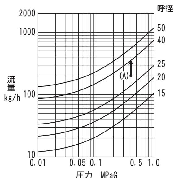
左記のグラフは管内流速を30m/sとした時の値です。圧力は使用圧力を示しています。使用圧力と使用流量の交点を求め、その交点より上側で交差するサイズラインが求める呼径です。
