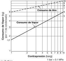
Consumo de Aire (m³)\* (por 1 t de condensado)
