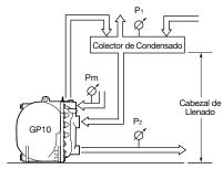
La capacidad de descarga es determinada por el medio motriz, la presión del medio motriz (P<sub>m</sub>) y la contrapresión (P<sub>o</sub>).
